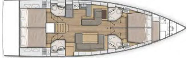
Die Anordnung im Salon bleibt gleich, die Kabinen und Bäder im Achterschiff sind wie bei 3-Kabinen-Version mit 3 Bädern angeordnet.
