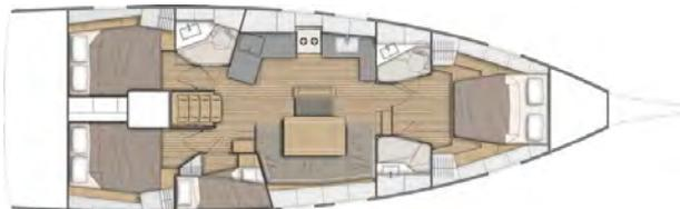
Das StB-Bad der Standardausführung wird durch eine Kabine mit Doppelstockkojen ersetzt:
