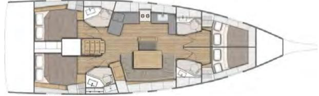
Die Anordnung im Salon bleibt gleich, die Kabinen und Bäder im Achterschiff sind wie bei 3-Kabinen-Version mit 3 Bädern angeordnet.
